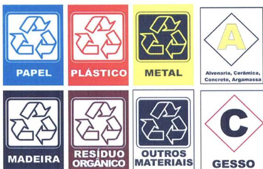
Figura 3 – Sinalização recomendada para os resíduos de construção civil, de acordo com a Resolução CONAMA n. 307/2002.
